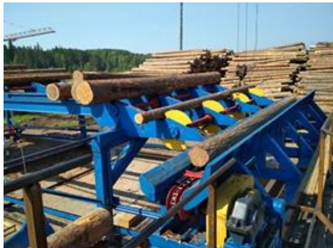
6) **Сортировочный транспортер с гидравлической системой сброса** – предназначен для одностороннего сброса бревен в карманы - накопители. Представляет собой двух цепной продольный транспортер с металлическими траверсами и гидравлической системой сброса. Направляющие транспортера снабжены фторопластовыми пластинами скольжения.
