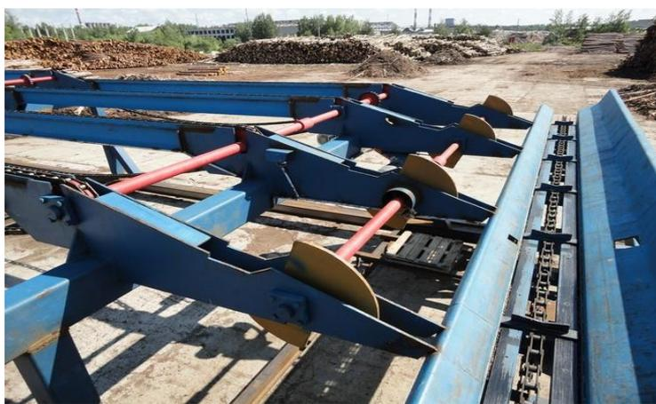
4) **Скребковый транспортер удаления отходов** – предназначен для уборки отходов из под столов и приемного транспортера. Представляет собой двух цепной поперечный транспортер с двумя стальными скребками и направляющими длиной 15,5 метров с приводом от мотор-редуктора.
